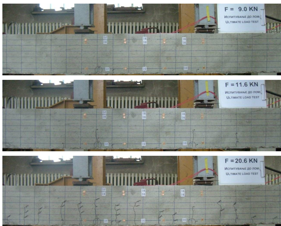
Slika 4. Razvoj pukotina karakteristične armirano-betonske grede sa čeličnim vlaknima Figure 4. Crack development for characteristic reinforced beam with steel fibers
